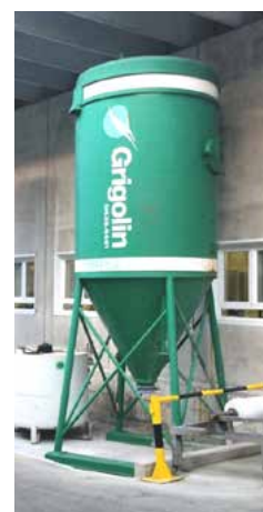
fornitura materiale sfuso con spandicalce per stabilizzare il terreno - ossido di calce ad alta reattività
