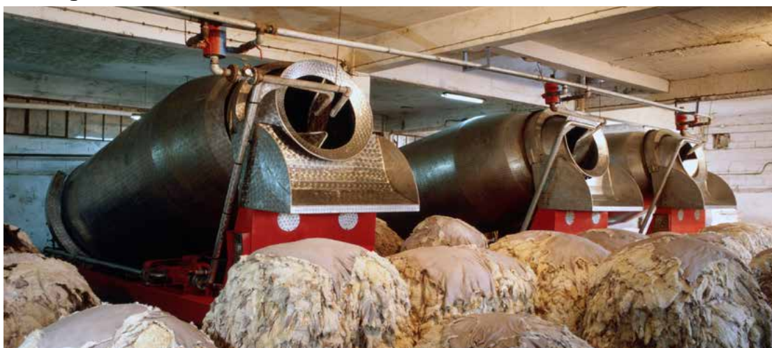
bottali utilizzati nella concia delle pelli
