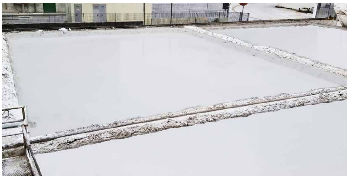
lo spegnimento della calce avviene in apposite vasche
