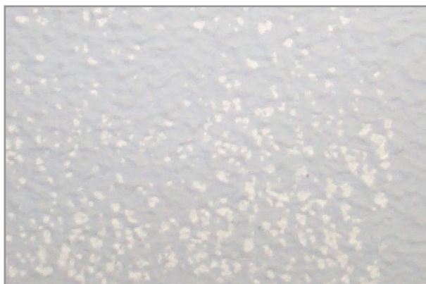
Foto 2: effetto "schivatura" causato da vetrificazione superficiale.
